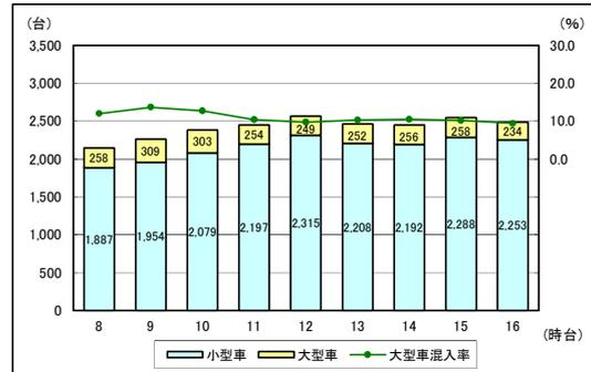
図Ⅲ.15 土曜日の交差点流量図、時間帯別の自動車類交通量(博多駅前3丁目交差点)
