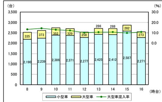
図Ⅲ.7 平日の交差点流量図、時間帯別の自動車類交通量(博多駅前3丁目交差点)
